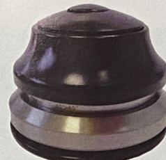
Le kit cadre Axxome RS Evo est accompagné de son jeu de direction haut de gamme Origine Inset Conique 1"1/8-1.5" avec des roulements étanches de haute qualité très fluide pour plus de précision de pilotage, monté en salle blanche. Il est livré avec un cône rehausseur en aluminium, de 10, 15, ou 25mm – au choix – taillé dans la masse avec joint torique et joint à lèvres pour un maximum de protection et d'étanchéité.
