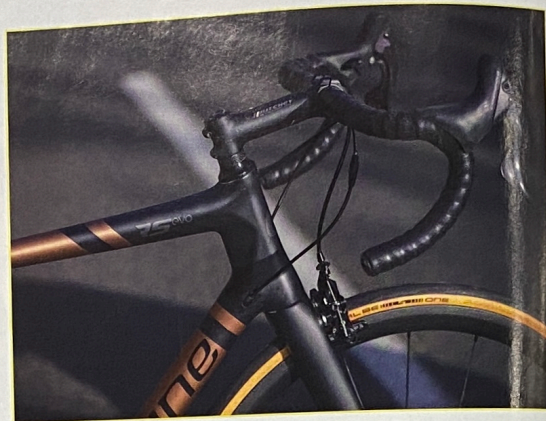
Ici, le vélo est monté en transmission mécanique. Si vous choisissez une transmission Di2, pas de problème : le cadre est livré avec un cache plein pour remplacer celui qui sert de butée pour le câble du dérailleur avant, afin d'occulter le trou.
