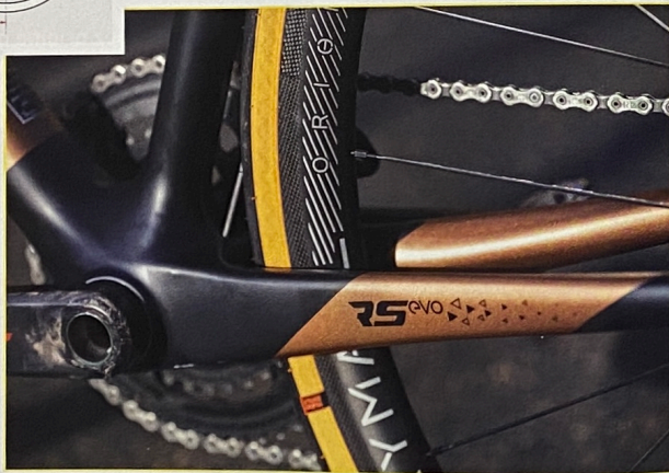
Origine reste fidèle au standard BB86 (86.5 X 41) pour son boîtier de pédalier full carbone, qui est compatible avec les pédales Shimano (ensemble de la gamme 24mm à partir du Tiagra, sauf les triples plateaux), Rotor (ensemble de la gamme 24mm + 30mm), Campagnolo (ensemble de la gamme UltraTorque et PowerTorque), Sram GXP uniquement (22/24mm), FSA MegaExo (24mm uniquement).
