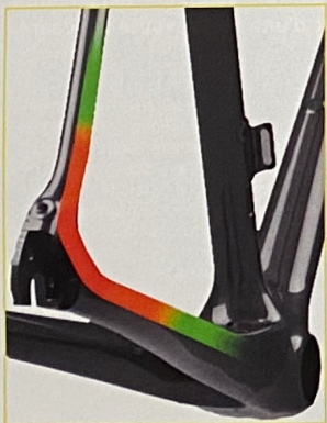
Le nouveau triangle arrière CCT+® améliore encore l'association rendement et confort. Les bases et les haubans des cadres Axxome sont reliés en un seul tube de carbone continu, sans point dur entre le boîtier et le puits de selle (Continuous Carbon Tubing®). Les vibrations créées par les imperfections de la route sont diffusées sur toute la longueur de ce tube continu (bases + haubans) pour une meilleure filtration.
