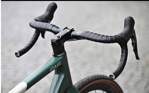
In deze nieuwe versie van de Graxx zijn de kabels mooi weggewerkt.
