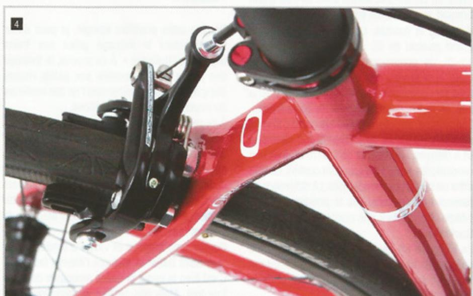
**1** Douille de direction en forme de sablier qui accueille un roulement inférieur de 1 pouce 1/5.
