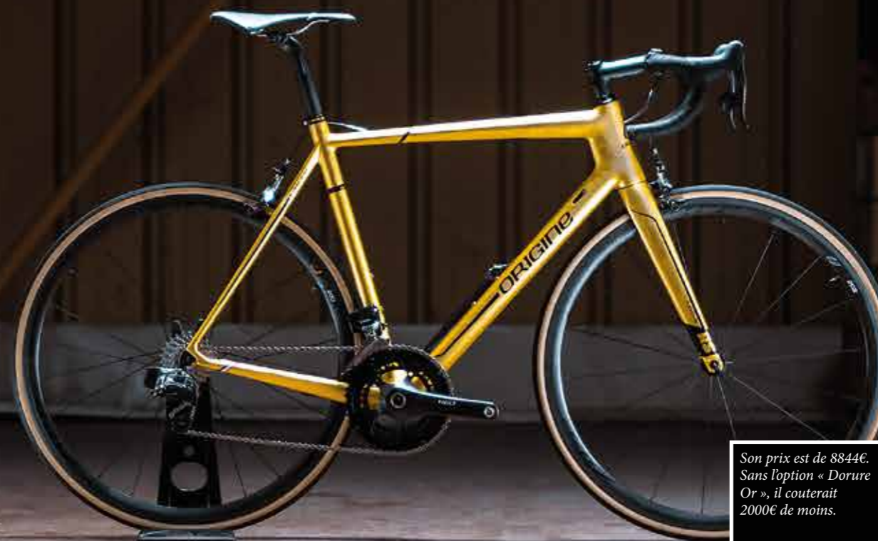
Il est équipé d'un groupe Red Etap, périphériques Ritchey WCS Carbon, potence WCS C220, roues Zipp 202.
