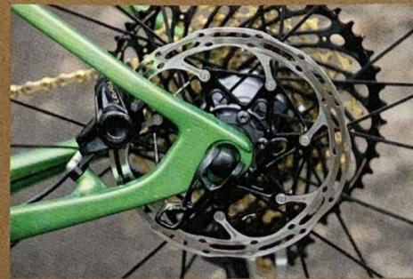
Équipé au top niveau dans cette version GTR, cet Origine dispose de freins Sram Level avec étrier fixé sur base AR. Encore et toujours de la rigidité.
