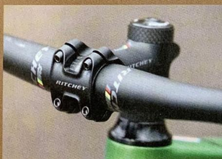
Un poste de pilotage qui déménage ! Avec un ensemble de composants Ritchey WCS, la petite potence de 70 mm est parfaite et retournable, si besoin de confort.
